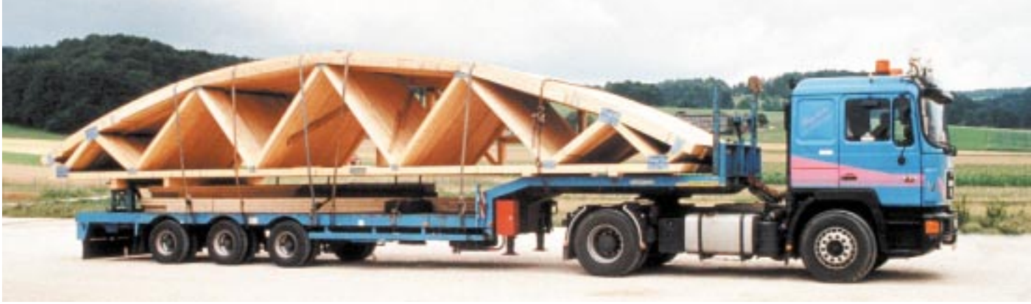
Abb. 10: Die präzise Vorfertigung und zuverlässige Anlieferung der gebogenen Nagelplattenbinder lässt eine ökonomisch optimierte Realisierung der Basistypen des Raumsystems der Turn-Mehrzweckhalle zu.
