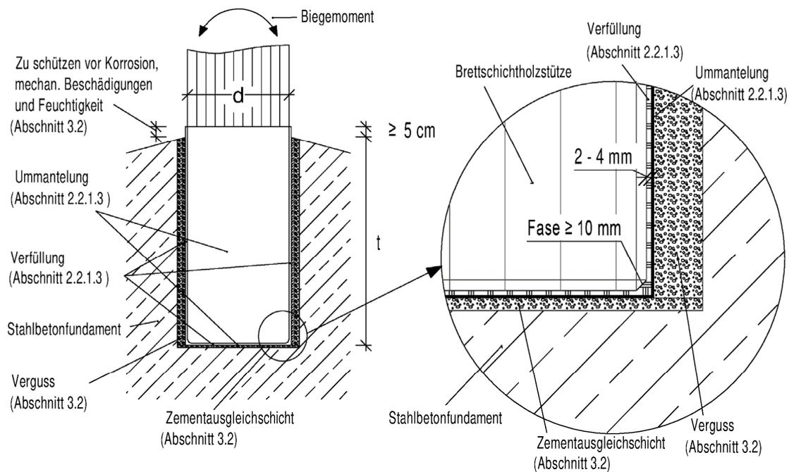
Stützen aus Brettschichtholz zur Einspannung durch Verguss in Stahlbetonfundamente
